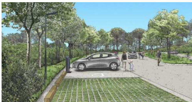
Principe de réalisation d'un parking public perméable
